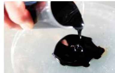
La liqueur noire, coproduit de la fabrication de pâte à papier, est riche en lignine.
